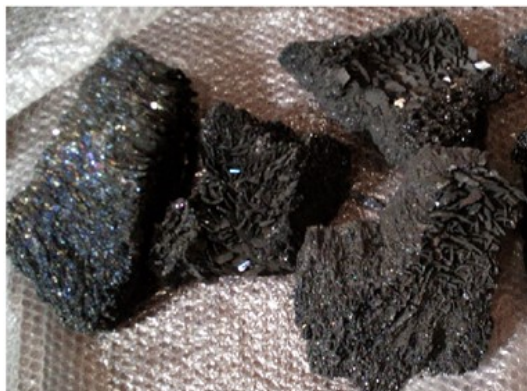
Рис. 2. Образцы необработанной друзы карбида кремния после процесса спекания Fig. 2. Samples of untreated drusen of silicon carbide after the smelting process
