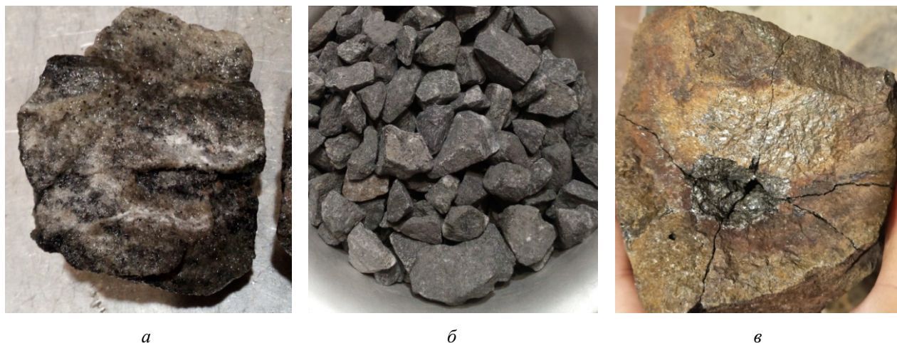
Рис. 1. Образцы горных пород и шлака, подвергнутые электроимпульсному воздействию: a — апатит-нефелиновая руда; б — железная руда; в — шлак медно-никелевого производства Fig. 1. Samples of rocks and slag subjected to electric pulse treatment: a — apatite-nepheline ore; б — iron ore; в — slag of copper-nickel production
